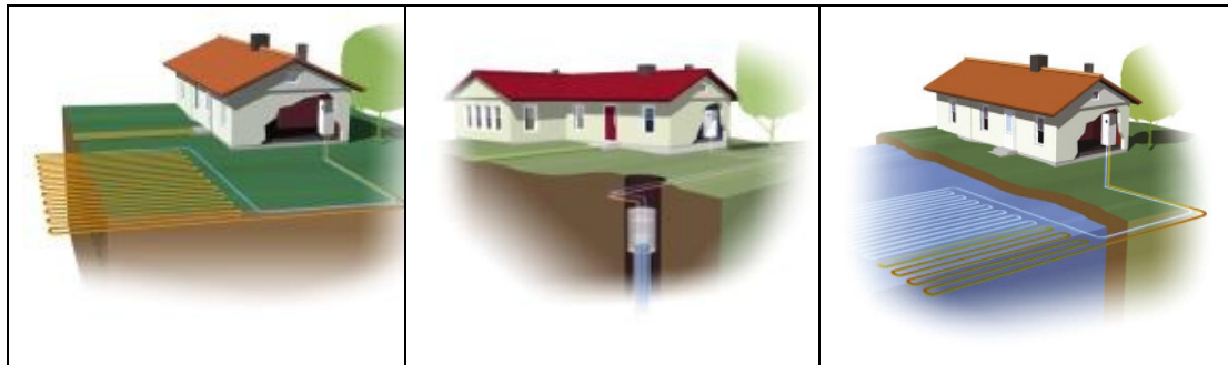
Pav. 7.5 Šilumos šaltiniai siurbliams: žemės paviršius, giluminis gręžinys, vanduo (Šaltinis: UAB Naujos idėjos, www.naujosidejos.lt ).
